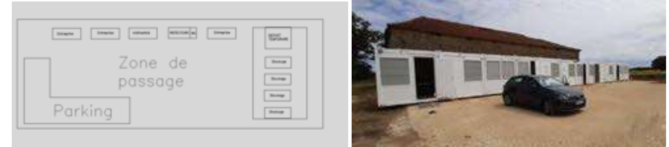
Figure 48 : Schéma de principe d'une base de vie (à gauche) et exemple de base de vie (à droite) Source : Q ENERGY
