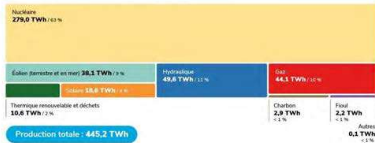
Figure 105 : Production d'électricité française par filière en 2022 92
