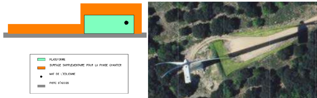
Figure 40 : Schéma de principe d'un emplacement d'éolienne (Source : Q ENERGY)
