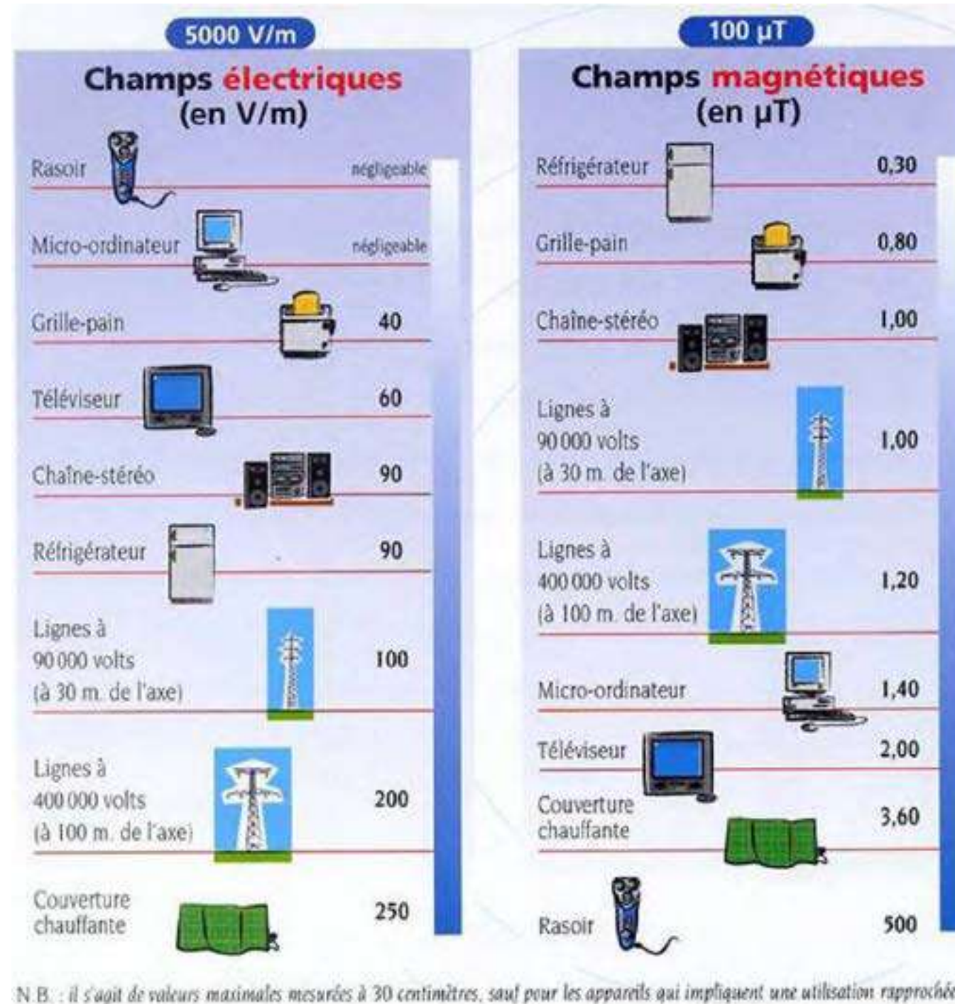
Figure 252: Comparaison entre champs électriques (en V/m) et champs magnétiques (en microteslas : μT) - (Source : RTE) 161
